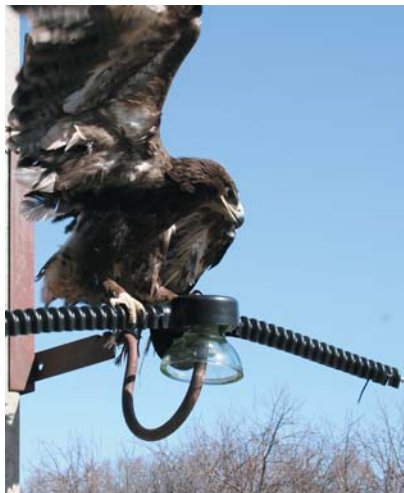
Рис 2. Степной орёл (Aquila nipalensis) на современном диэлектрическом птицевозащитном устройстве в момент стендовых испытаний (Россия, Ульяновск, 2010).
